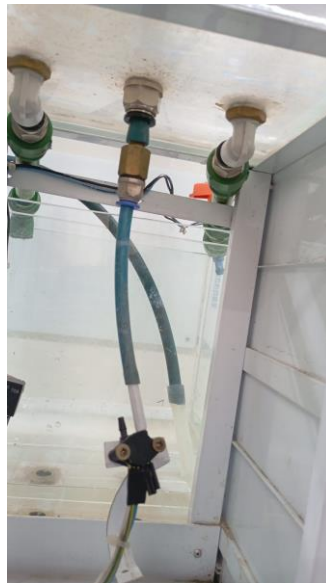
Figura 6 — Conexão do sensor na parte inferior da planta
