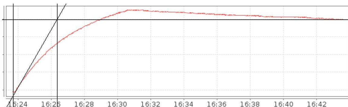
Figura 12 — Equilíbrio estático do nível com método de Ziegler-Nichols aplicado
