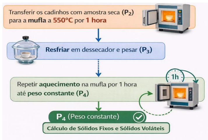
Figura 2 - Fluxograma para determinação de Sólidos Fixos (SF) e Sólidos Voláteis (SV)
