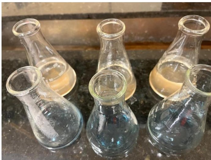
Figura 2. ponto final da titulação para a determinação da dureza total ( \text{Ca}^{2+} + \text{Mg}^{2+} ).
