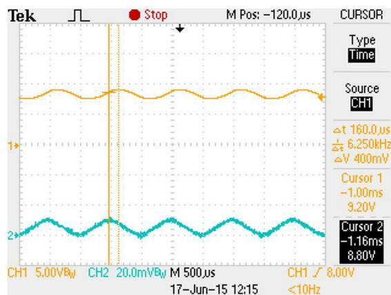
Figura 4. Tensão (amarelo) e corrente (azul), medidas com aplicação da forma de onda triangular – teste realizado em voluntário
