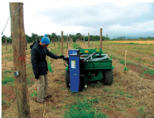
Figura 7 - Penetrômetro posicionado no lado esquerdo da rua
