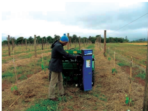
Figura 8 - Penetrômetro posicionado no lado direito da rua
