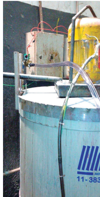
Figura 12 - Tambor e a válvula solenóide
