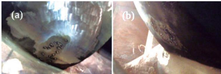
Figura 1 – Erosão causada pela cavitação. a) Cavitação em bolhas itinerantes. b) Cavitação em nuvem
