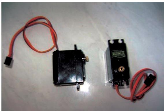
Figura 3 - Servomotores
