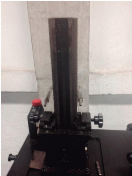
Figura 2 - Máquina de entalhe em "V" para Charpy tipo A
