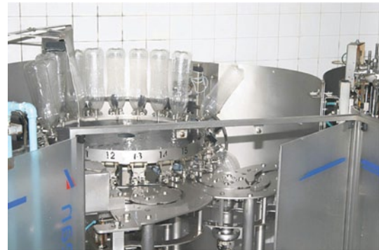
Figura 2: Máquina de envasamento de refrigerante (cortesia: IRL).
