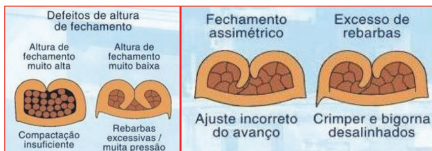
Figura 3 - Ilustração de uma crimpagem incorreta
