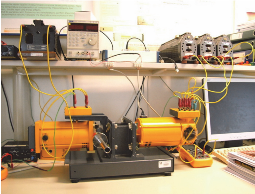
Figura 8 - Estrutura de teste montada para simulação de falhas em motores
