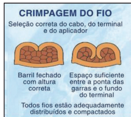
Figura 2 - Ilustração de uma crimpagem correta
