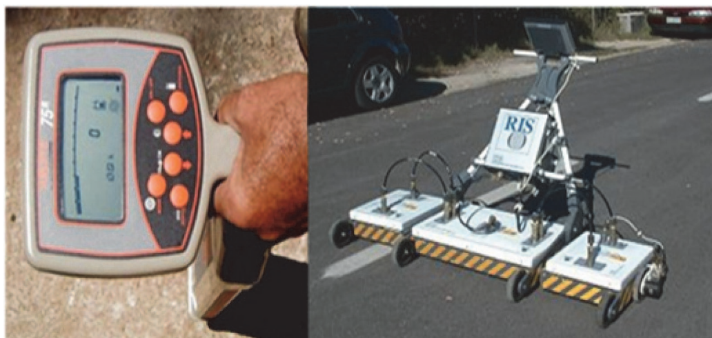
Figura 3 - O pipe locato” e o georradar. Fonte: PMSP - SMIEU, 2005
