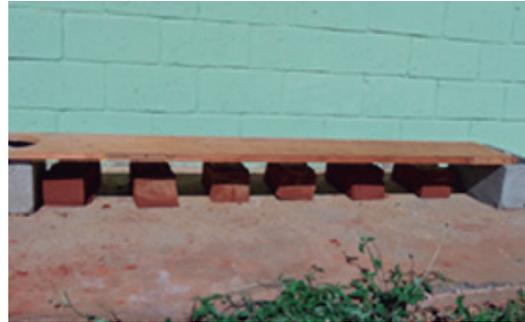
Figura 08 - Desforma dos tijolos
