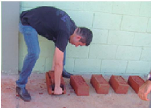
Figura 07 - Desforma dos tijolos
