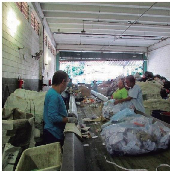
Figura 3 - Circulação dos sacos plásticos na esteira sendo abertos para a triagem
