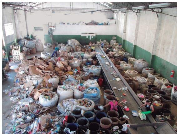
Figura 1 - Detalhe da mesa separadora com esteira rolante para a seleção de material reciclável
