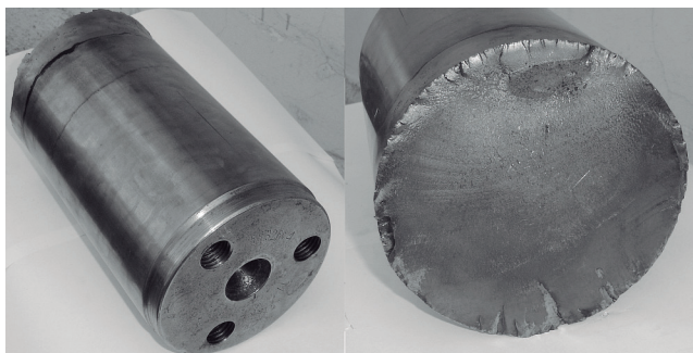
Figura 1 - Fratura por fadiga em eixo ferroviário
