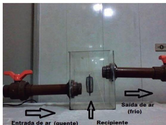
Figura 3 – Protótipo do secador
