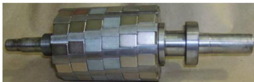
Figura 3 – Rotor protótipo com ímãs de inclinação intermediária  $-5^\circ$
