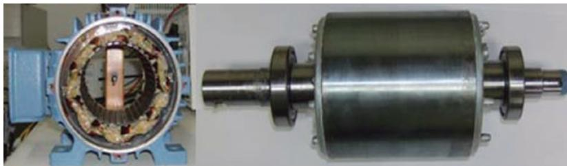
Figura 1 – Motor de indução trifásico rotor gaiola de esquilo padrão
