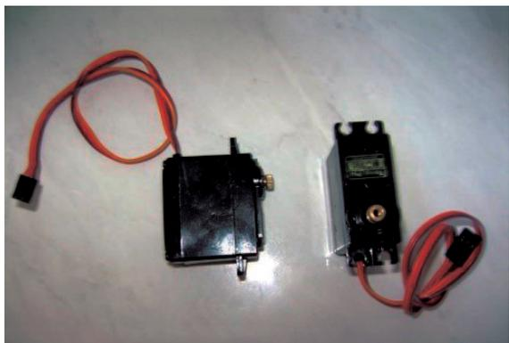
Figura 3 - Servomotores
