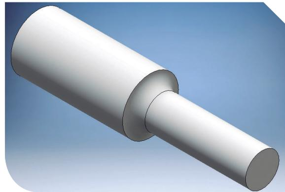
Figura 1 - Modelo de eixo com rebaixo arredondado
