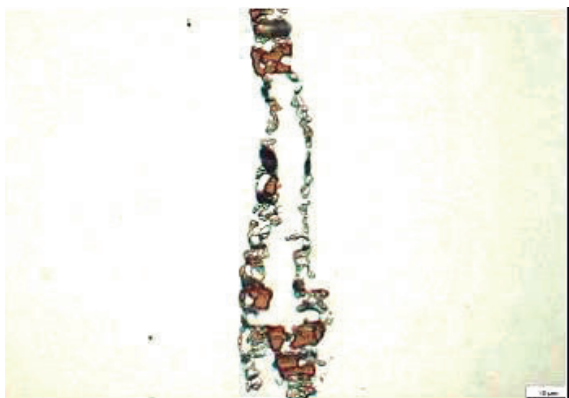
Figura 5 - Caracterização da fase Sigma em Aço Inoxidável AISI 316. Adaptado de Xiaoli Tang - Swagelok Company - EUA - 2005
