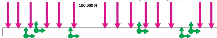
Figura 13 - Cargas e apoios da estrutura
