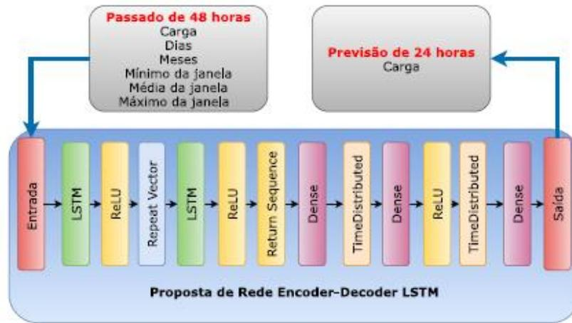
Figura 9 – Rede Encoder-Decoder LSTM proposta para a previsão de carga.
