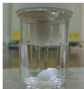
Figura 2 – Eletrodos mergulhados na solução ácida, pode-se ver a barra magnética no fundo do béquer
