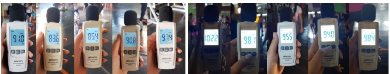
Figura 6: Aferição diurna e noturna das máximas de NPS, tomada durante os treinamentos, acusando valores entre 83,6 e 102 dB (A), muito acima da faixa de conforto preconizada pela norma técnica situada entre 45 e 50 dB (A). Fonte: imagem do autor.
