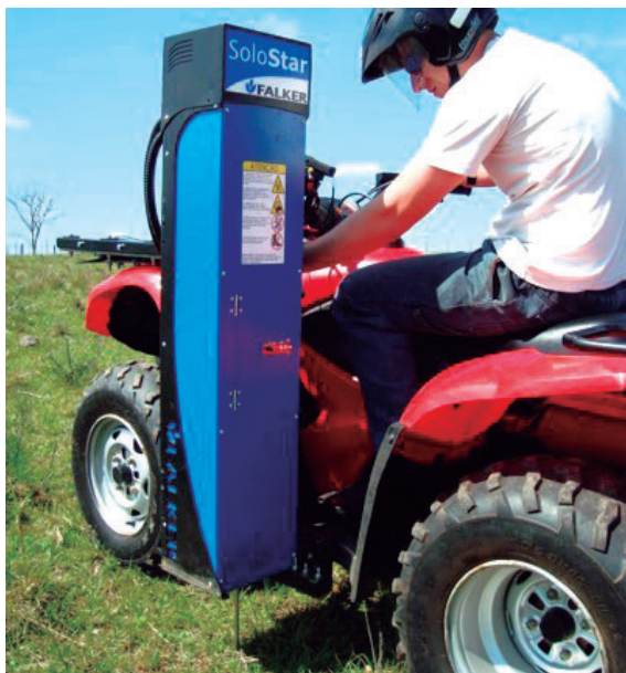
Figura 1 - Penetrômetro eletrônico instalado na lateral de um quadriciclo Fonte: http://www.falker.com.br/Produto.php?id=6 .
