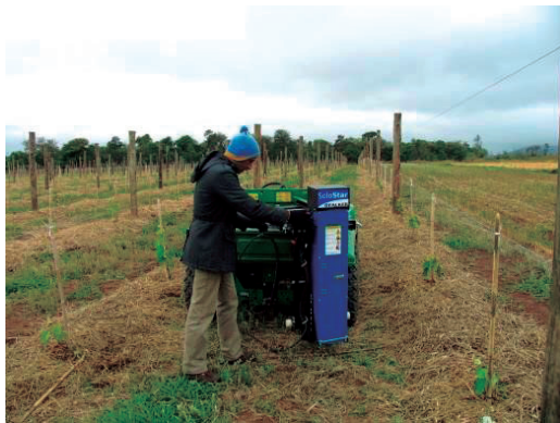
Figura 8 - Penetrômetro posicionado no lado direito da rua
