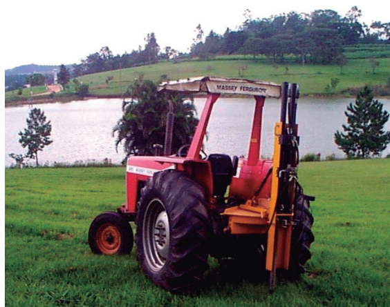
Figura 2 - Penetrômetro acoplado ao trator Fonte: Maziero e Storino, 2014.
