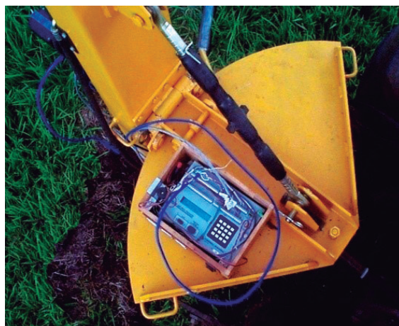
Figura 3 - Detalhe da base com rodízios para deslocamento lateral e sistema eletrônico de captura de dados Fonte: Maziero e Storino, 2014.
