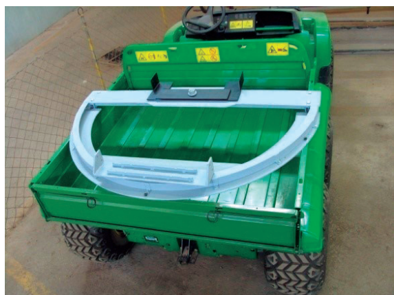
Figura 4 - Base semicircular para a colocação do penetrômetro eletrônico
