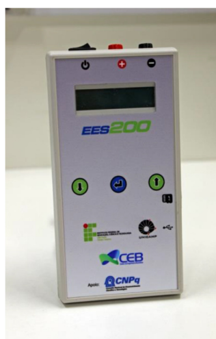
Figura 3. Nova versão do equipamento indutor de sudorese (EES200)
