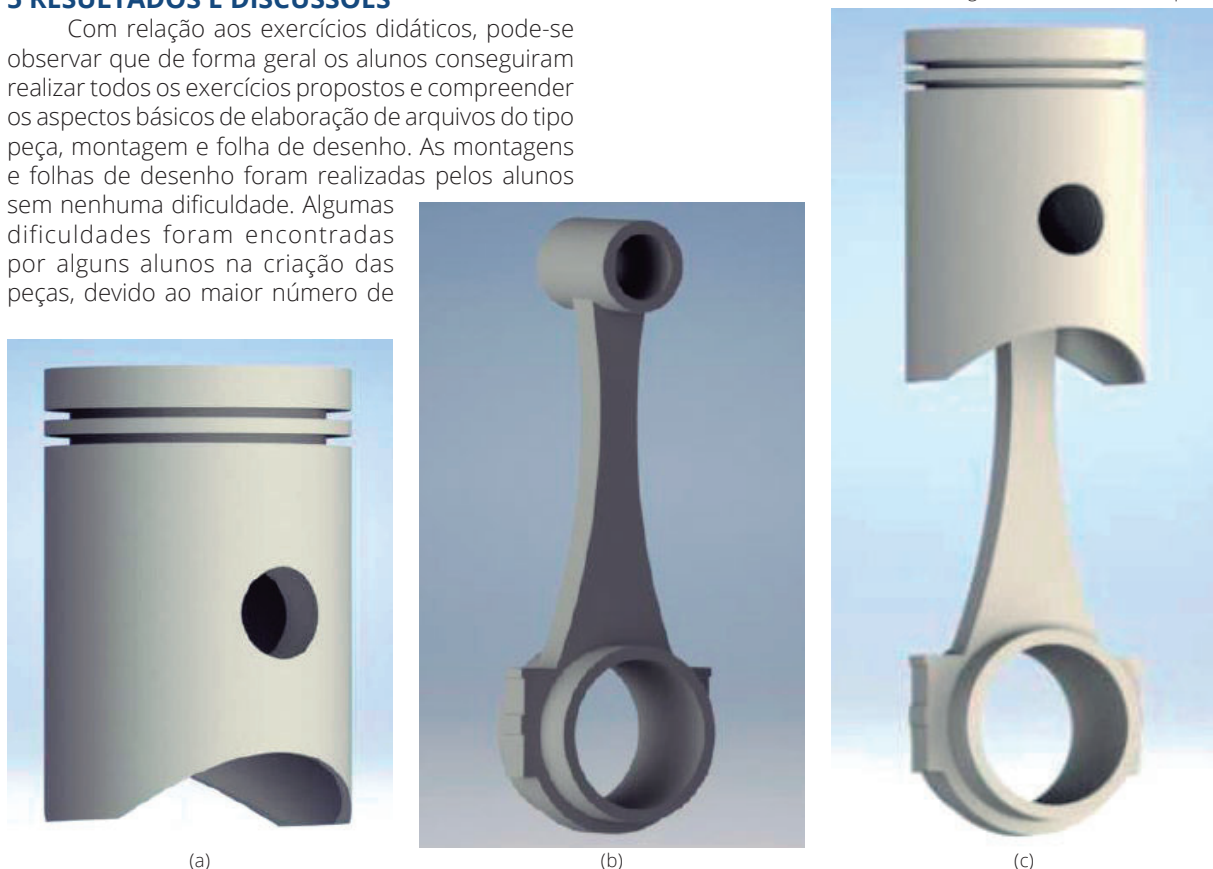
Figura 2 – Mecanismo formado pelo pistão e pela biela de um motor de combustão interna. (a) Peça pistão. (b) Peça biela. (c) Montagem do mecanismo completo
