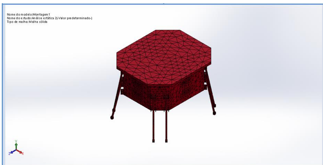
Figura 11: Malha aplicada à estrutura.
