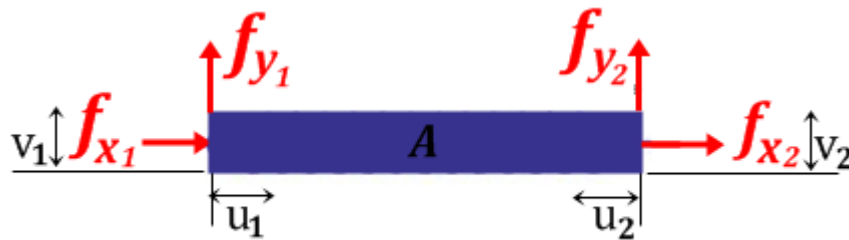
Figura 3 (a): Análise de esforços referente a viga “a” da trelça apresentada na figura 6. Fonte: próprio autor.
