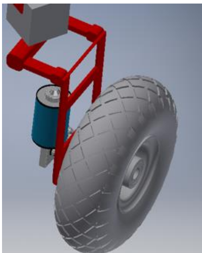
Figura 6: Detalhe das garras inferiores: roda e motor. Fonte: próprio autor.
