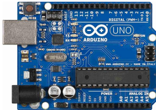
Figura 3 – Placa Arduino UNO utilizada no projeto de pesquisa
