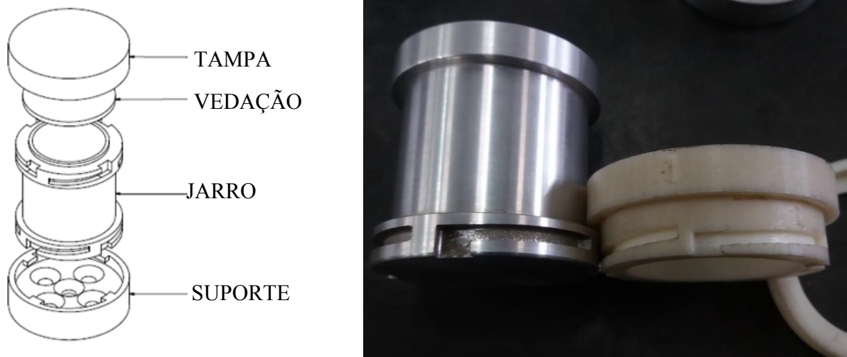
FIGURA 4. Jarro com engate rápido (a) Projeto virtual do conjunto. (b) Protótipo e jarro fabricado.
