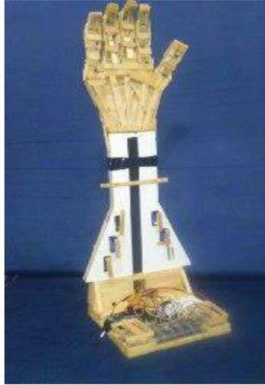
Figura 2 - Protótipo da mão robótica artesanal.
