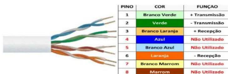
Figura 2: Cabo de par trançado e tabela de dados do cabo (parte interna).
