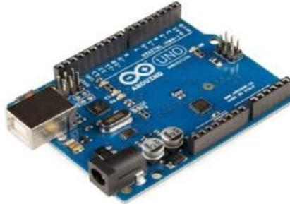
Figura 3 – Arduino Uno. (Fonte: Arduino Uno)
