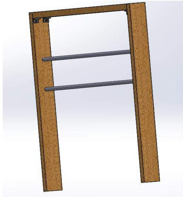
**Figura 11 – Laterais que formam o pórtico da estrutura. Desenho em SolidWorks.**
