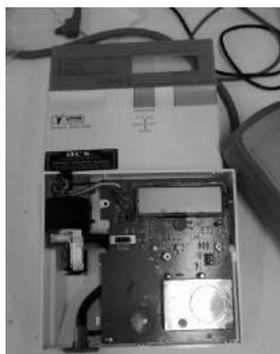
Figura 1. Medidor de frequência cardíaca e pressão arterial da VIVA<sup>®</sup> aberto
