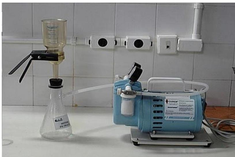
**Figura 3: Sistema de filtração de impurezas sólidas presentes nos óleos lubrificantes.**
