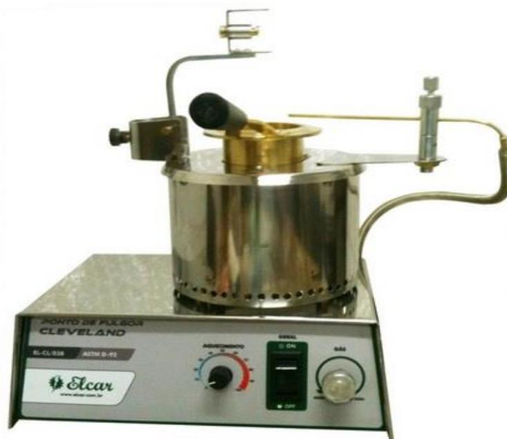
**Figura 1: Aparelho para medir ponto de fulgor de vaso aberto Cleveland.**
