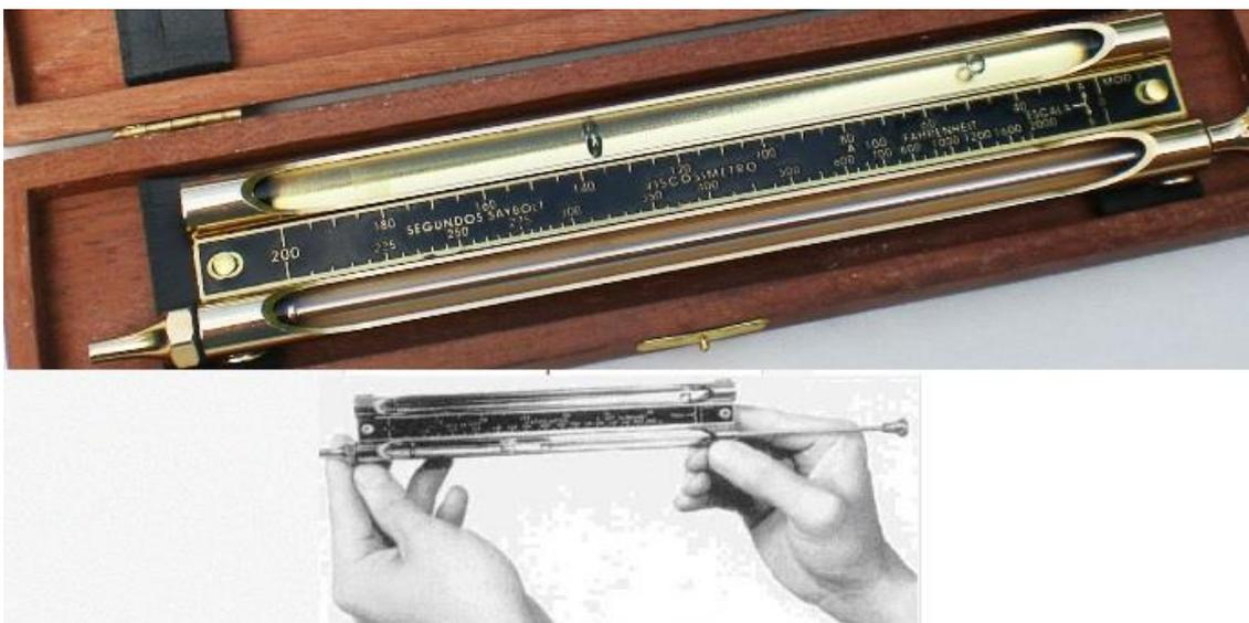
**Figura 2: Aparelho de medir viscosidade Visgage.**
