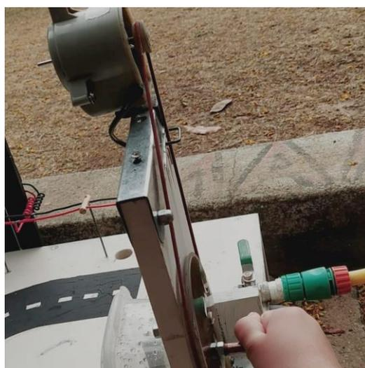
**Figura 2. Foto ilustrativa do experimento de geração de energia elétrica pelo fluxo da água.**
