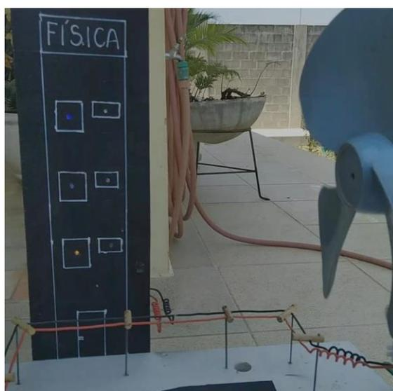
**Figura 4. Foto ilustrativa da montagem dos LEDs que acendem com a geração de energia elétrica no experimento.**
