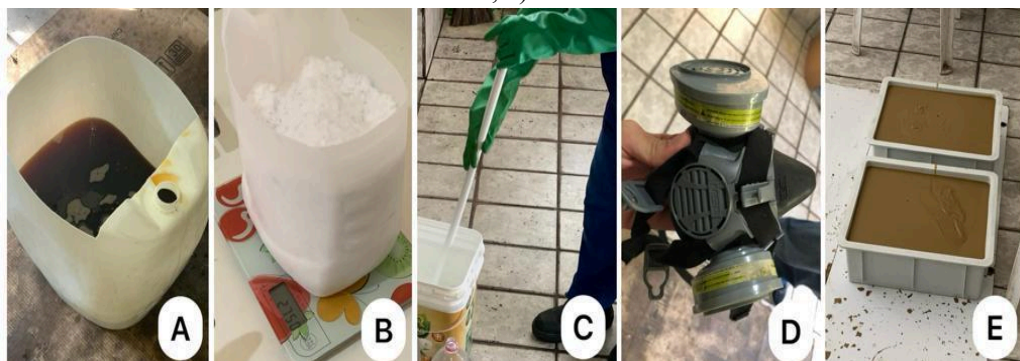
Figura 4 – a) ORF; b) Pesagem da soda cáustica; c) Dissolução da soda com uso de EPI; d) Máscara facial; e) Sabão
