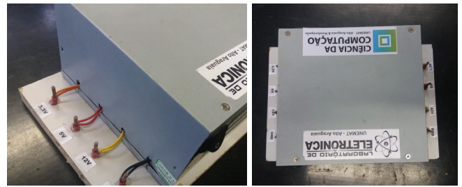
Figura 6 – Fonte Computador adaptada para funcionar como Fonte de Bancada.
