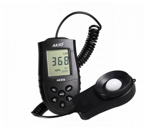
Figura 8 - Luxímetro utilizado nas medições
