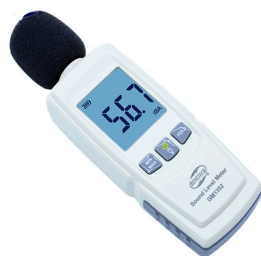
Figura 3 - Decibelímetro usando nas medições
