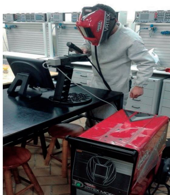
Figura 3 - Simulador de soldagem.(Laboratório de automação do IFSP)
